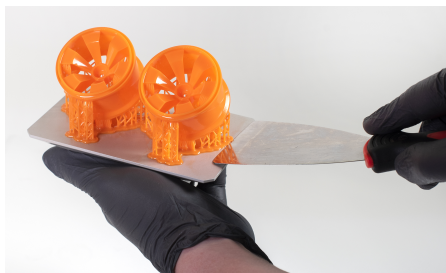
Odstranění vytištěného objektu kovovou špachtlí
