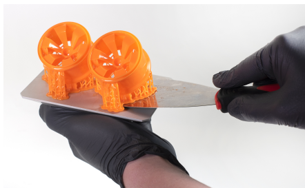
Odstranění vytištěného objektu kovovou špachtlí
